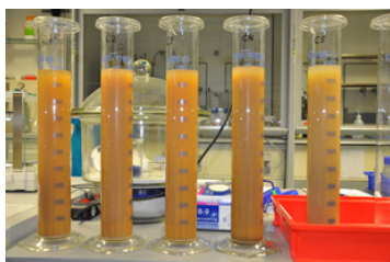
Abb. 5: Neben Schadstoffuntersuchungen müssen beim Einsatz in technischen Bauwerken auch physikalische Eigenschaften bestimmt werden (hier: Korngrößen).
