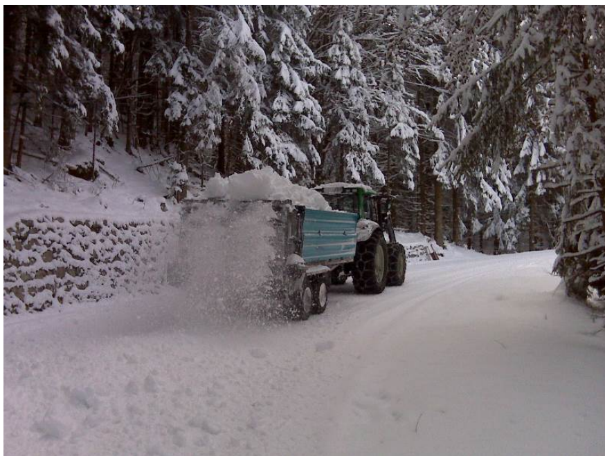
Abbildung 3: Foto einer vergleichbaren Schneeausbringung mittels Miststreuer bei der Winterrodelbahn am Wallberg (Gde. Rottach-Egern am Tegernsee, Bayern)
